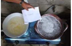
Bittern yang direbus dengan wajan alumunium dan tanah liat
