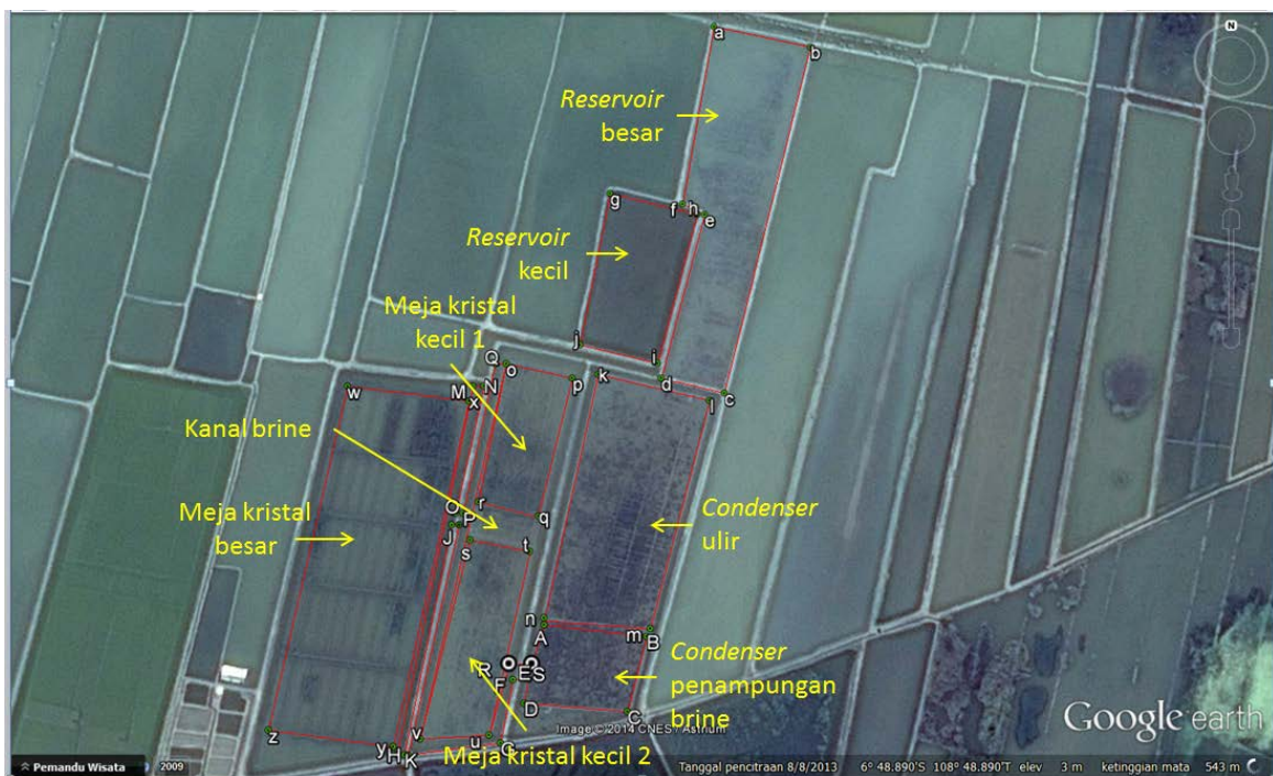
Gambar 2. Struktur Tambak Garam Teknologi Ulir Filter
