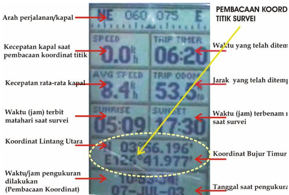
Gambar 1. Pembacaan koordinat pada GPS Garmin 3+ Sumber: BRKP, 2003
