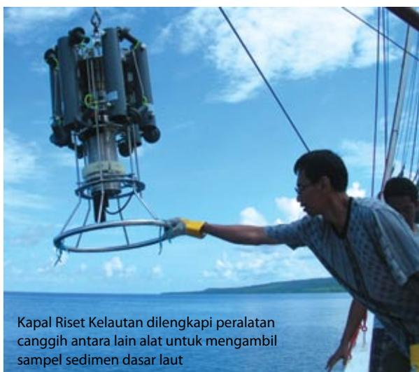
Kapal Riset Kelautan dilengkapi peralatan canggih antara lain alat untuk mengambil sampel sedimen dasar laut
