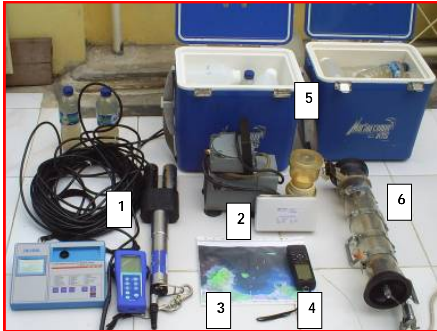
Gambar 2. Peralatan yang digunakan untuk survei lapangan. Keterangan : 1 = multiparameter DKK TOA (pH, suhu, DO, salinitas, klorofil & tss in situ ), 2 = vacuum pump untuk menyaring sampel, 3 = peta citra berkoordinat yang mencantumkan posisi titik sampling, 4 = GPS, 5 = coolbox dan 6 = water sampler (van dorn)
