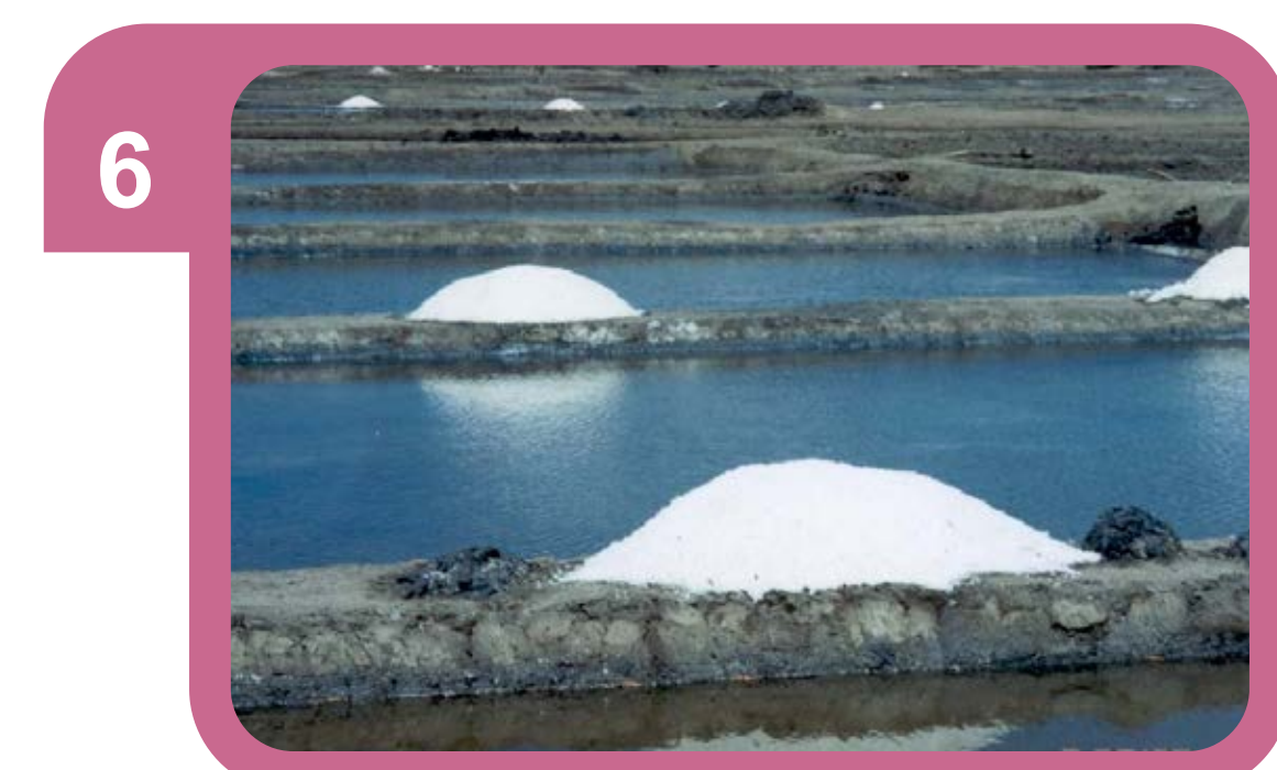
6 Garam hasil Panen yang siap dilakukan proses pencucian. Nilai kadar NaCl dibawah standart. Lokasi Desa Pijot Kab. Lombok Timur Propinsi NTT
