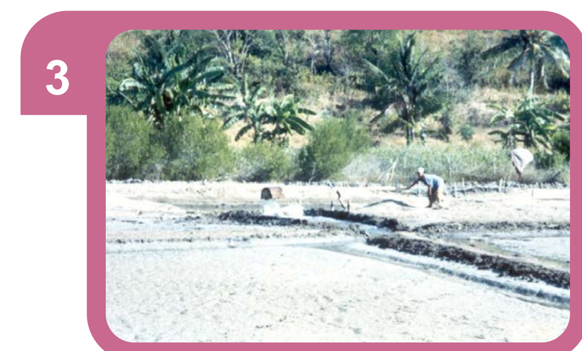
3 Pengambilan air laut dari kolam penampungan/waduk/bozem ke kolam peminihan/kolam penguapan. Kedalaman Kolam Peminihan 20 cm. Lokasi Kampung Sekuit Kab. Lombok Tengah Propinsi NTB.
