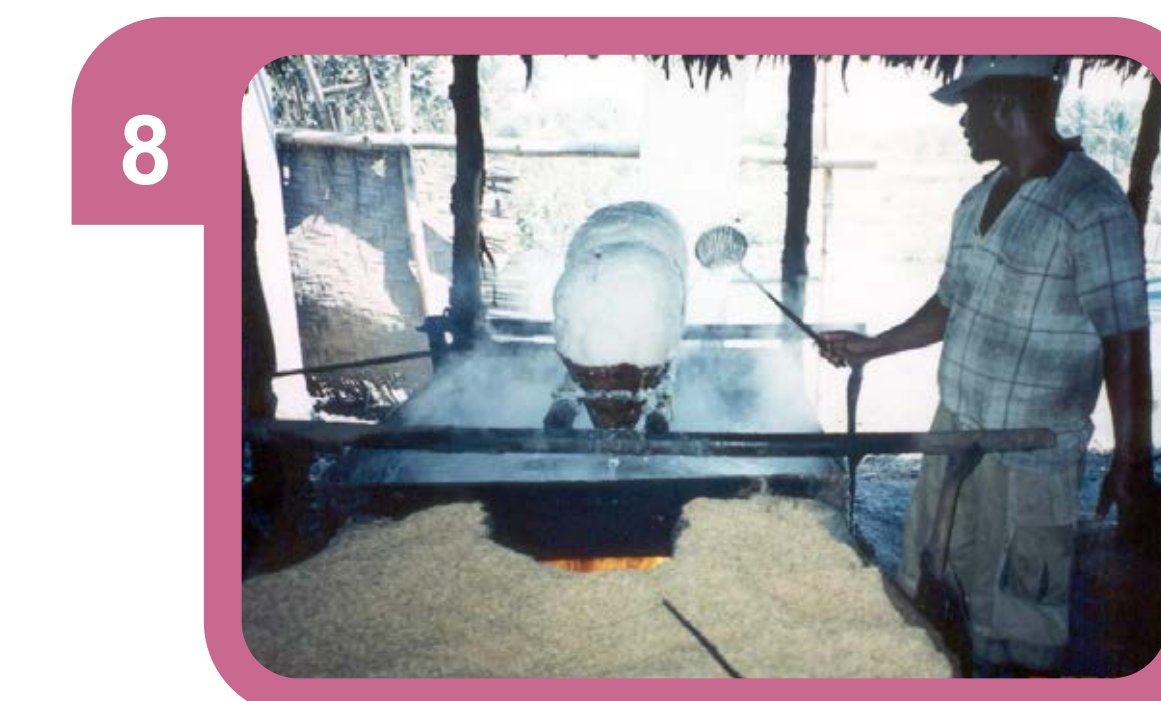
8 Proses pencucian garam dimasak selama 8 jam, dapat menaikkan kadar NaCl. Lokasi Desa Pijot Kab. Lombok Timur Prop. NTB.
